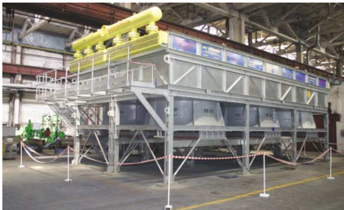
Рис. 1. Аппарат Айсберг поставляется четырьмя блоками в полной заводской готовности
