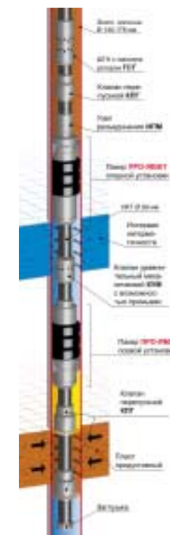
Двухпакерная компоновка для эксплуатации скважин с глубинными насосами с изоляцией негерметичности эксплуатационной колонны 2ПРОК-УОИВ-1
