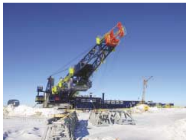
Буровая установка Уралмаш 5000/320 ЭК-БМЧ , сделанная для ОАО «Газпромнефть», на месторождении
