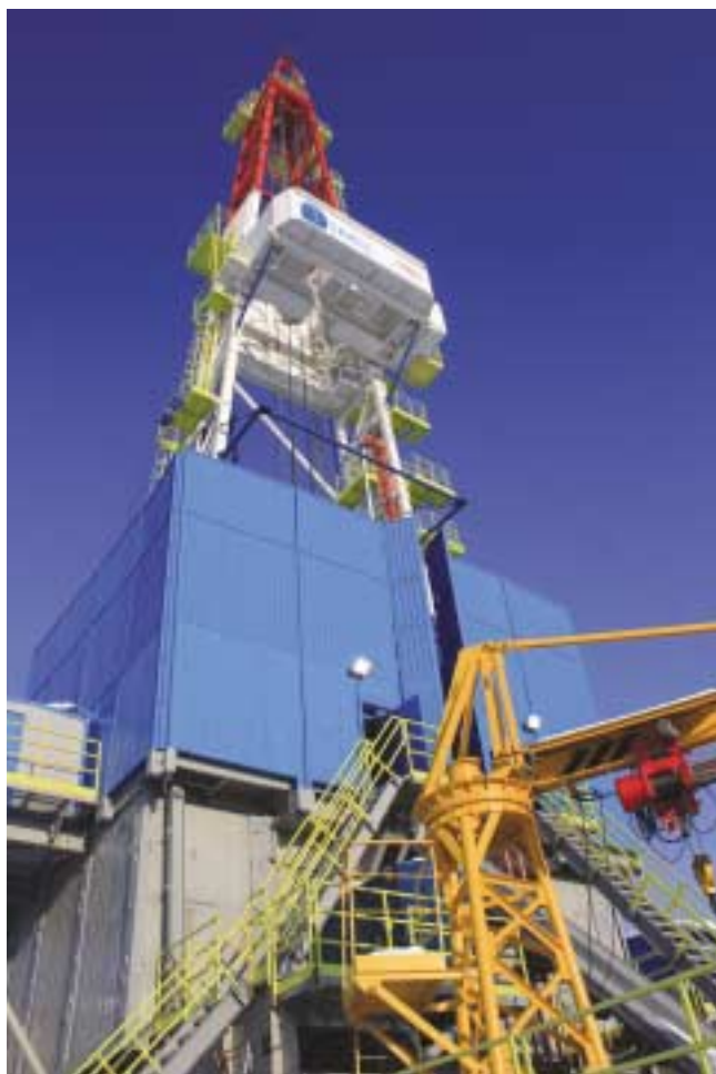
Буровая установка типа Уралмаш 5000/320 ЭК-БМЧ-Е , произведенная для компании «Eriell»
