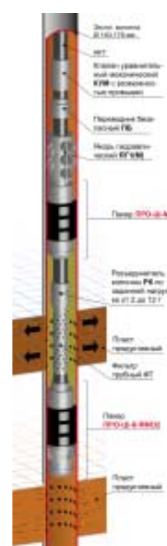
Двухпакерная компоновка 2ПРОК-СО-2 для селективных обработок пластов
