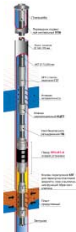
Пакерная компоновка для изоляции верхнего водопритока в добывающих скважинах при эксплуатации УСШН 1ПРОК-УО-1
