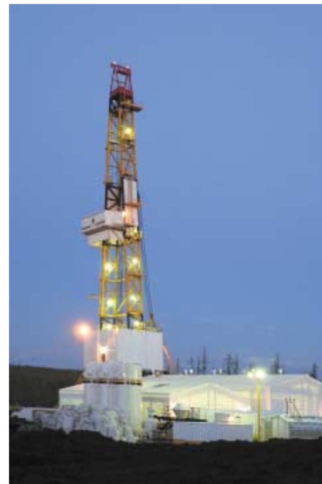
Буровая установка Уралмаш 5000/320 БМ(Ч), произведенная для компании «Роснефть»
