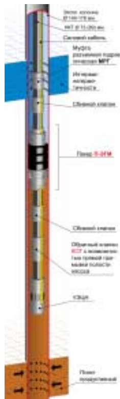
Пакерная компоновка для изоляции верхнего водопритока в добывающих скважинах 1ПРОК-ИВЭ-1
