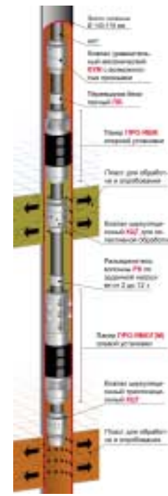
Двухпакерная компоновка 2ПРОК-СОД-2 для селективных обработок пластов
